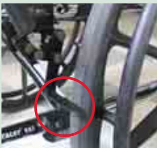
Le frein est enclenché lorsqu'il touche au pneu.
